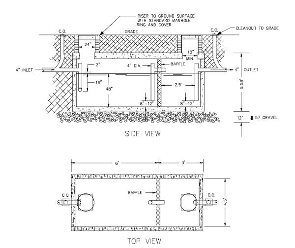
TYPICAL UNDERGROUND GREASE TRAP
